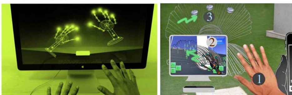
Fot. 4.16. Somatosensoryczny czujnik Leap Motion jako sterowanie środowiska trójwymiarowego oraz leap motion użyty w instalacji Czarna Perła jako sensor interfejsu łączącego świat fizyczny z wirtualnym.
